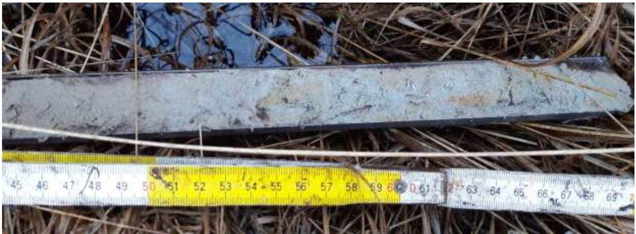
Figuur 4-2 Grondboring met keileem ten zuiden van het centrale compartiment
